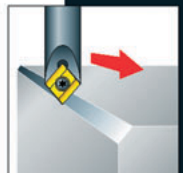
Hoeken- en zijkanten verzinken en ontbramen
